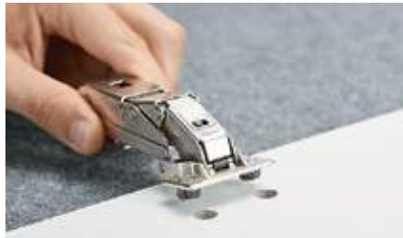
Dübel in die Bohrlöcher setzen...
