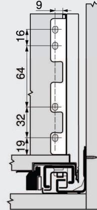
Schraubposition der Korpuschienen – 40 kg
