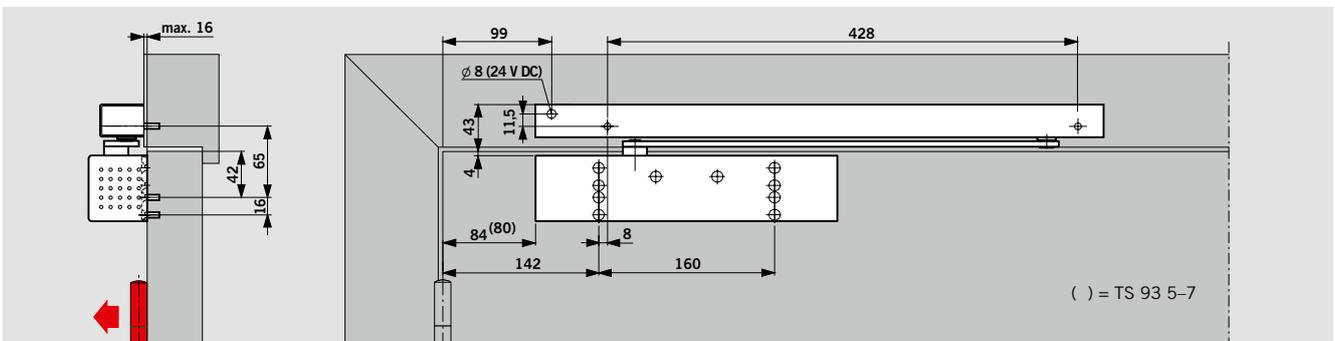
Türschließer **TS 93 B** mit Gleitschiene G-EMF, Montage auf der Bandseite
