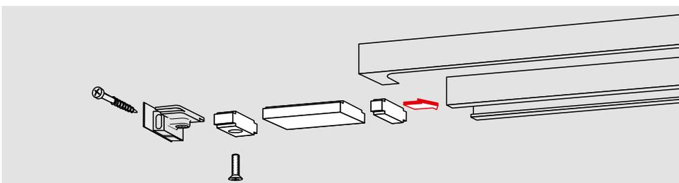
Zubehör für Gleitschiene G-N: **Öffnungsbegrenzung** zum nachträglichen Einschub in die Gleitschiene. Einstellbar zwischen 80° und **max. 120°**.
