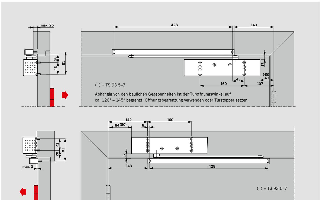
Türschließer **TS 93 G** mit Gleitschiene G-N in Türblattmontage auf der Bandgegenseite und Sturzmontage auf der Bandseite
