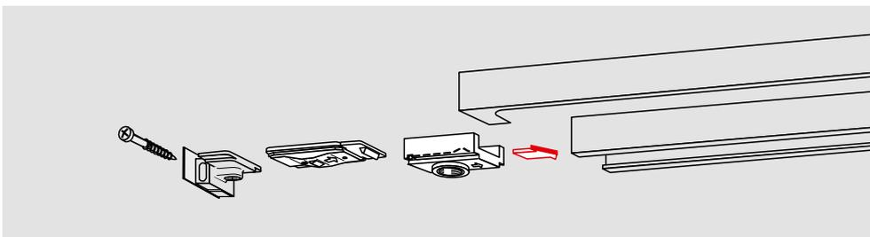
Die Rastfeststelleinheit **RF** ermöglicht ein exaktes Feststellen von Türen ohne Rückfederung bis zu einem Öffnungswinkel von ca. 150°. Die Rastfeststellung lässt sich bei Bedarf vom Benutzer einfach ein- und ausschalten,
