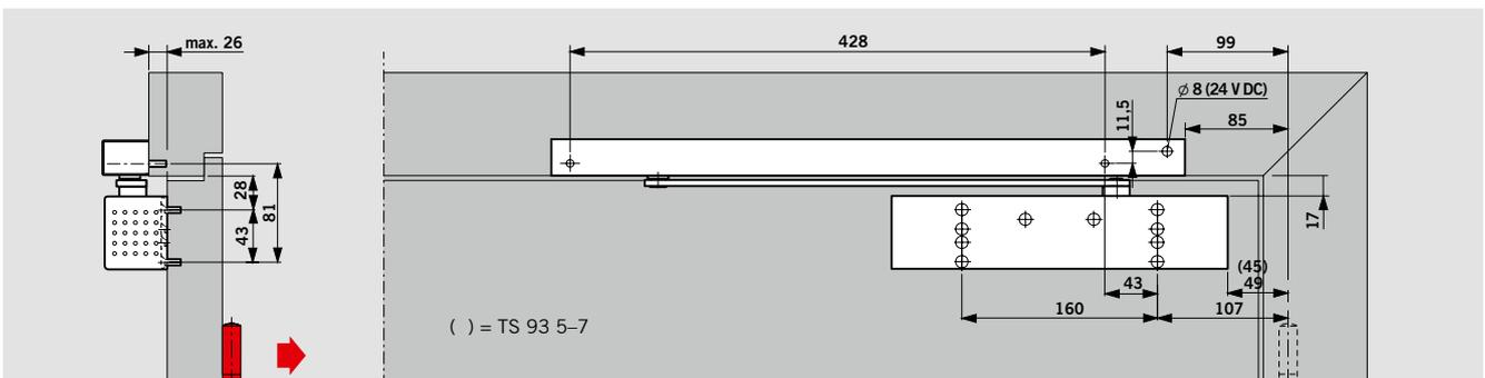
Türschließer **TS 93 G** mit Gleitschiene G-EMF, Montage auf der Bandgegenseite
