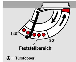
Die Gleitschiene **G-EMR** ermöglicht es, Feuer- und Rauchschutztüren so auszurüsten, dass sie sich exakt feststellen lassen und völlig unabhängig von anderen Systemen überwacht und gesteuert werden. Der Feststellpunkt ist auf einen Öffnungswinkel zwischen ca. 80° und 140° einstellbar.
