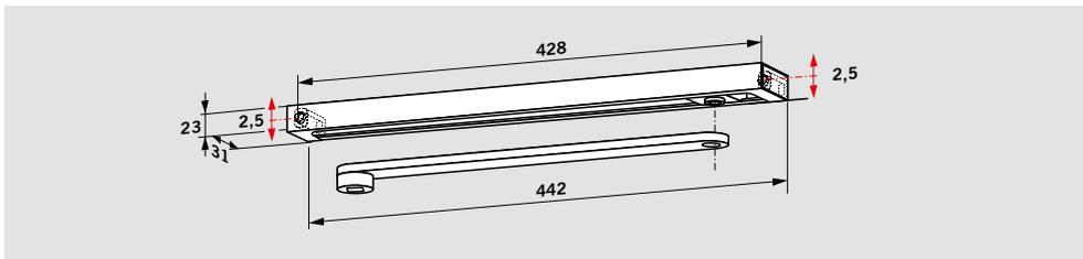
Die Gleitschiene **G-N** umfasst Hebel, Gleitschiene, Gleitstück, Befestigungsstücke, Schrauben und Endkappen. Die Gleitschiene DORMA G-N ist sowohl für DIN-
