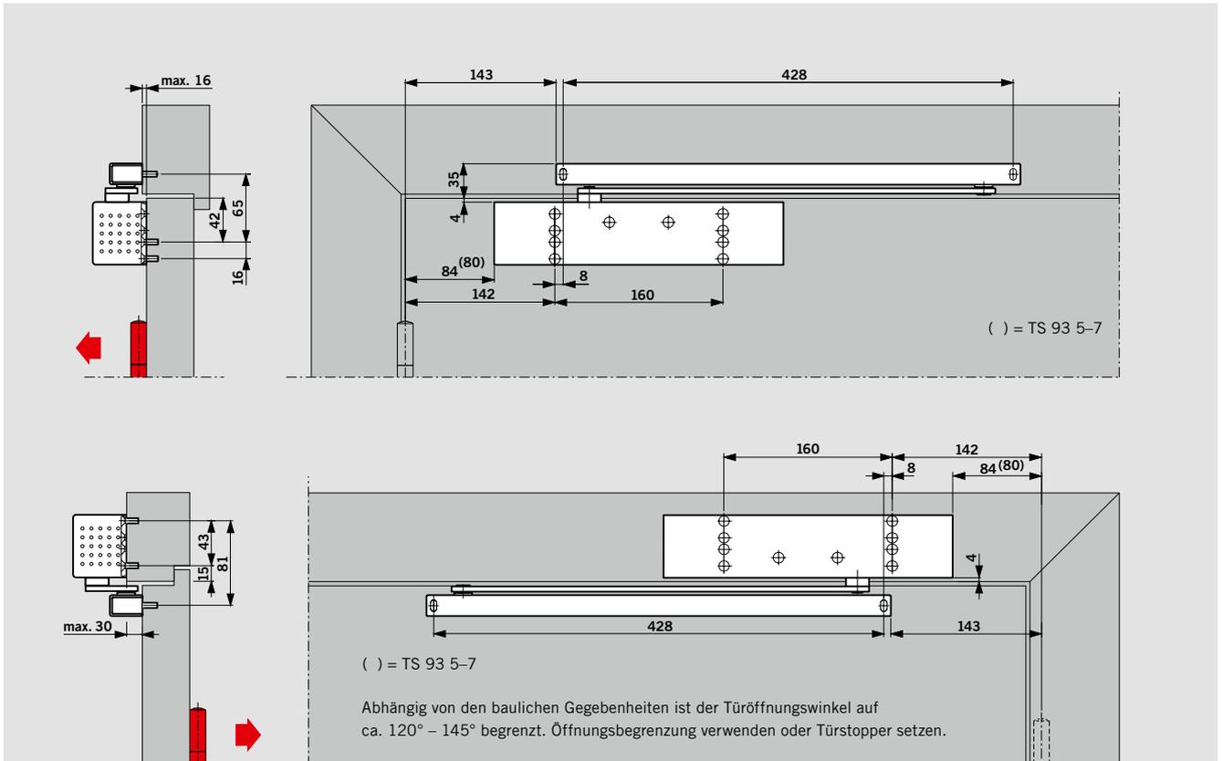
Türschließer **TS 93 B** mit Gleitschiene G-N in Türblattmontage auf der Bandseite und Sturzmontage auf der Bandgegenseite
