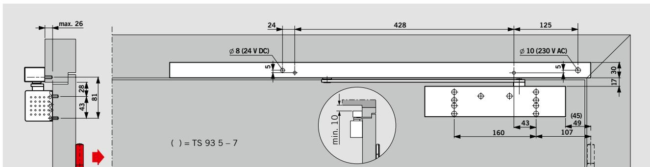
Türschließer **TS 93 G** mit Gleitschiene G-EMR, Montage auf der Bandgegenseite
