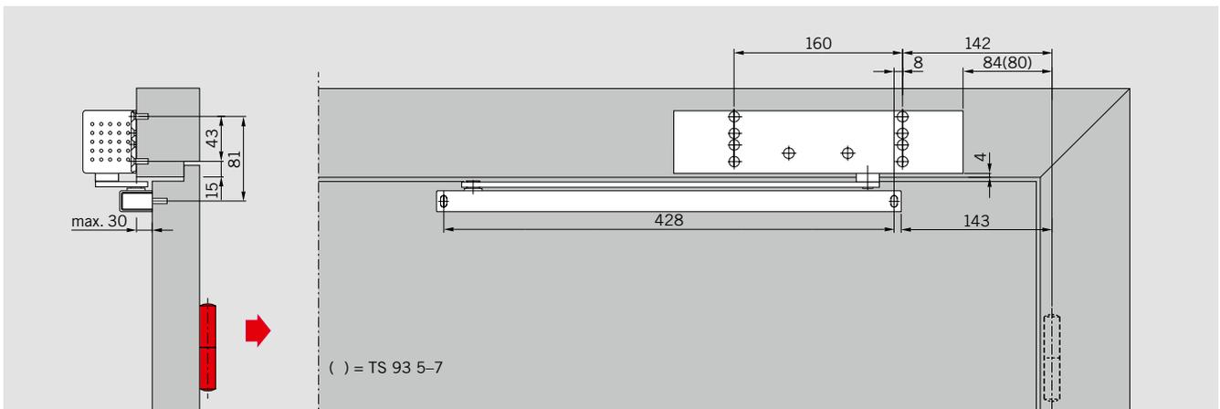
Sturzmontage (Kopfmontage) des TS 93 B auf der Bandgegenseite. Öffnungs-dämpfung und Schließverzögerung sind bei dieser Montageart nicht wirksam.
