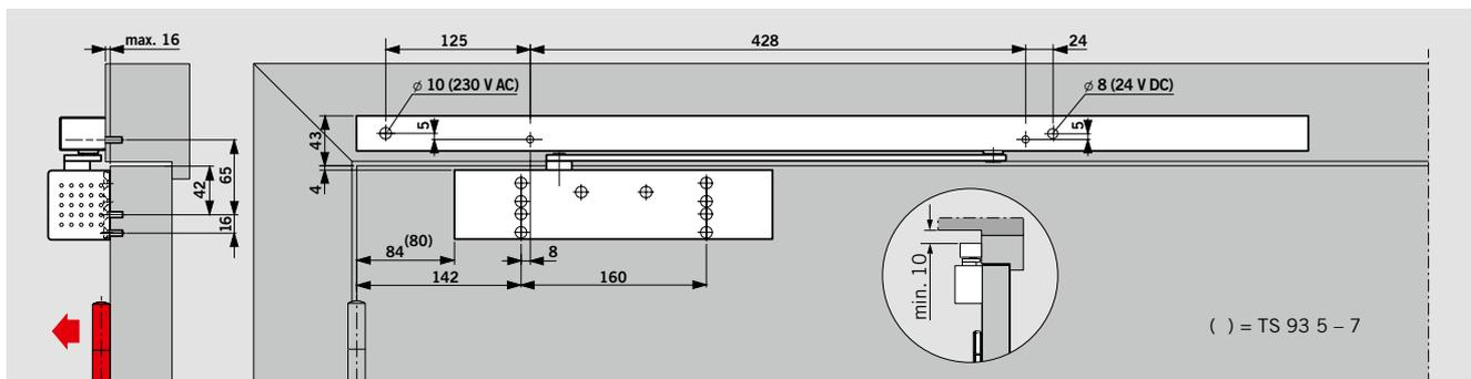
Türschließer **TS 93 B** mit Gleitschiene G-EMR, Montage auf der Bandseite
