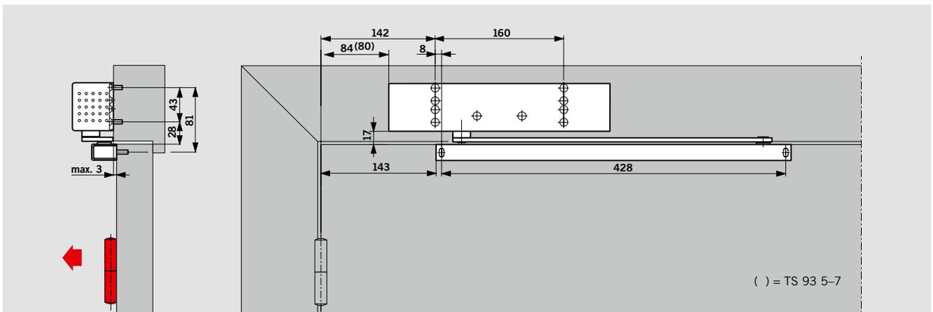
Sturzmontage (Kopfmontage) des TS 93 G auf der Bandseite.
