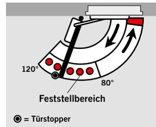
Die Gleitschiene **G-EMR** ermöglicht es, Feuer- und Rauchschutztüren so auszurüsten, dass sie sich exakt feststellen lassen und völlig unabhängig von anderen Systemen überwacht und gesteuert werden. Der Feststellpunkt ist auf einen Öffnungswinkel zwischen ca. 80° und 120° einstellbar.
