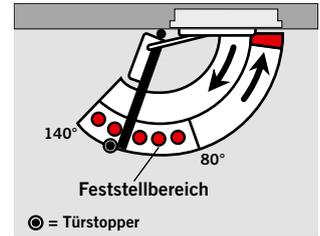
Die Gleitschiene **G-EMF** ermöglicht ein exaktes Feststellen der Tür ohne Rückfederung. Der Feststellpunkt ist auf einen Öffnungswinkel zwischen ca. 80° und 140° einstellbar.
