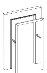
Geben Sie nun zur Befestigung der Zierbekleidung auf der Rückseite des Türfutters punktweise Weißleim in die Längs- und Quernut, und schieben Sie die Zierbe-kleidung auf. Durch leichte Schläge mit der Hand (oder einem Gummihammer) wird die Zierbekleidung endgül-tig fixiert. Abschließend versiegeln Sie die Anschlussfu-
