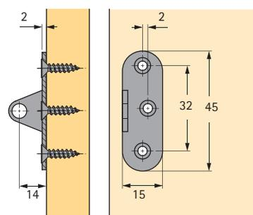
Befestigung mit Holzschrauben DIN 95 / DIN 97  $\phi$  3,5 und Spreizmuffen  $\phi$  5 mm
