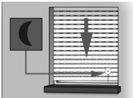
Bei Eintritt der Dämmerung senkt sich der Rollladen nach ca. 10 Sekunden bis zum unteren Endanschlag. Der Rollladen öffnet sich erst wieder bei Erreichen der eingestellten Öffnungszeit oder nach manuellem Auf-Befehl.
