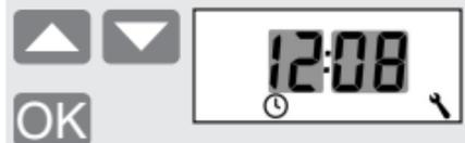
Wird eine Taste gehalten, erfolgt die Verstellung der Ziffern mit ansteigender Geschwindigkeit.
