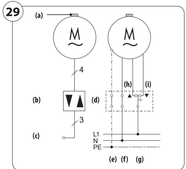
**i** Bei Verwendung eines Schalters ist es empfehlenswert, nach Erreichen der Endpunkte den Motor spannungsfrei (Schalter in Null-Stellung) zu schalten. Dadurch werden Störquellen oder Überspannungen vom Motor ferngehalten.
