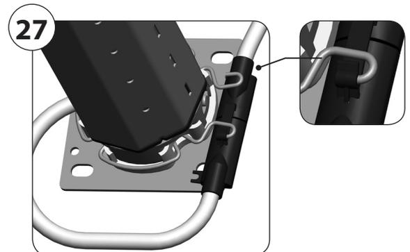
Der Federring (14) sollte bei Bedarf um 90° gedreht aufgesteckt und wieder eingerastet werden.
