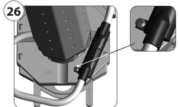
**Fixierung der Steckverbindung durch Festklemmen am Federring eines Click-Antriebslagers:**
