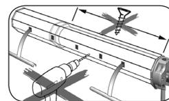
**Das Bohren und Eindrehen von Schrauben im Bereich des Antriebs führt zur Zerstörung des Antriebs.**
